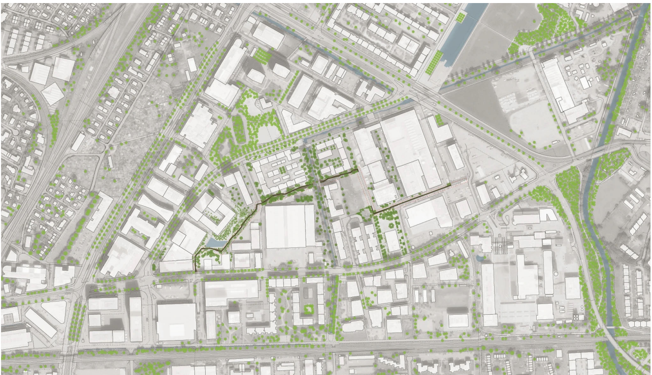
Der Plan zeigt, wie der «Innere Garten» sich durch das ehemalige Gewerbe- und Dienstleistungsquartier schlängelt und die Rückseiten der tiefen Grundstücke mit dem Strassenraum, den Parks und dem Naherholungsgebiet verknüpft.
